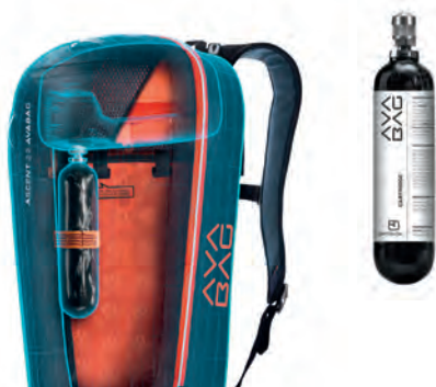
← Das mechanische System von Ortovox wird über einen Bowdenzug ausgelöst: Die Nadel sticht die Gaskartusche an, Gas tritt aus und füllt den Airbag.
